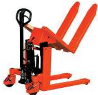
TRANSPALETA INCLINADORA Capacidad: 1.000 Kg. Medidas: 560 x 800 Mm. Horquillas inclinables 90º (Opción elevación eléctrica)
