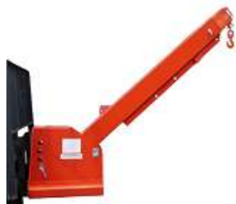
GRÚA CARRETILLA Capacidad: 3.000 Kg. Brazo: 2.020 hasta 3.700 Mm. Capacidad: 5.000 Kg. Brazo: 1.460 hasta 3.700 Mm.
